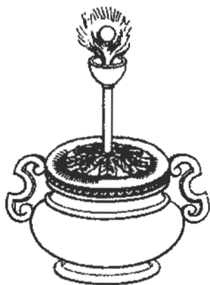
赫倫設計的氣力球。從這件玩具上可以看到一個小球因蒸汽噴出而懸浮於空中。
